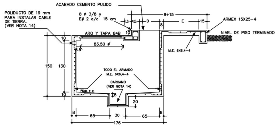
ELEVACION REFUERZO SECCION A-A'
